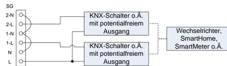
L+N sind an eine dauerhafte Spannungsversorgung angeschlossen
