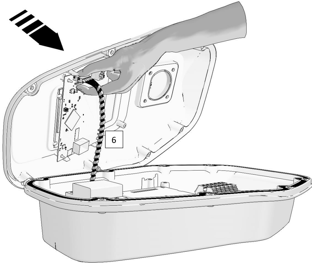
Bild 6 Entfernen des Verbindungskabels
