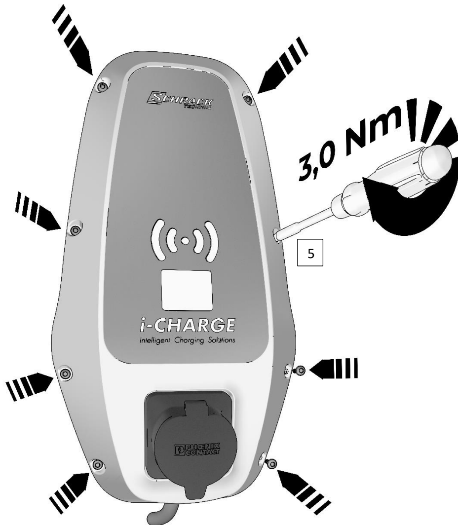
Bild 15 Deckelmontage
